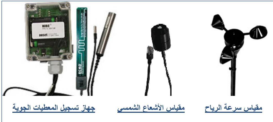
شكل 6.6 : مكونات محطة الارصاد الجوي المصغرة
