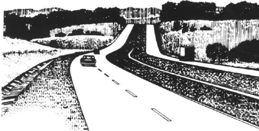
مظهر الطريق بدون استخدام منحنيات انتقالية حلزونية
